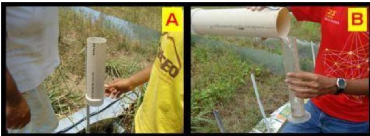
*Figura 4: (A) Pluviômetro utilizado para aferição dos índices pluviométricos. (B) Proveta milimetrada utilizada.*
